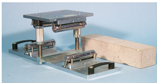
S106 Устройство для испытаний на изгиб с приложением нагрузки в двух точках или в средней точке бетонных балок 100x100x400 (500) и 150x150x600 (750) мм СТАНДАРТЫ: EN 12390/5 - UNI 6133 - NF P18-407 – UNE 83305 ASTM C78, C293 - AASHTO T97 - BS 1881:118
