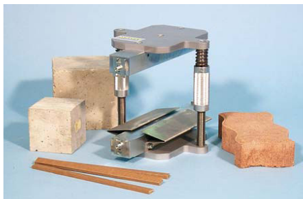
S103 Устройство для определения прочности при раскалывании, для испытаний бетонных кубов 100 и 150 мм, а также бетонной тротуарной плитки. СТАНДАРТЫ: EN 12390/6 - EN 1338 Вес: 26 кг
