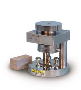
E170-01 Приспособление для испытаний на сжатие половинок призм раствора 40,1x40x160 мм после испытаний на изгиб. Используется с машинами для сжатия бетонных образцов, имеющими дополнительный пониженный диапазон нагрузки (мод. C097-01 – рекомендуемый диапазон 0 - 150 кН).
