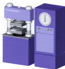
Предназначены для статических испытаний на сжатие стандартных образцов бетонов по ГОСТ 10180, кирпича и других строительных материалов.
