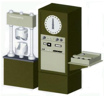
Предназначены для статических испытаний образцов металлов и сплавов, арматурной стали, образцов из листового и круглого проката на растяжение при температуре  $(20 \pm 15)$ °C. Машины с торсионным силоизмерением, оснащены системой измерения, позволяющей производить испытания с заданной скоростью нагружения, обеспечивающей измерение перемещения активного захвата и его индикацию, запись результата на самопишущем двухкоординатном приборе, включая запись деформации образца с навесного тензометра.
