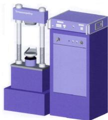
**Машины для испытания образцов из асфальтобетонных смесей на сжатие типа ПС-1**
