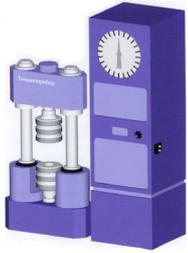
Предназначена для статических испытаний образцов сварных соединений на растяжение, изгиб по ГОСТ 6996.
