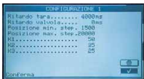
Рабочие параметры машины в меню расширенной конфигурации, защищенном паролем (модели Cybertronic и Servotronic)
