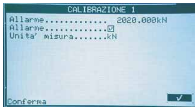
9 • В режиме расширенной калибровки оператор может задать максимальное значение нагрузки, при котором машина будет автоматически остановлена и нагрузка будет снята.
