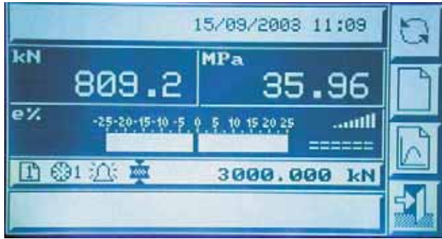
1 • Типовой экран дисплея во время выполнения испытания. Отображаются иконки, числовые данные и индикатор скорости приложения нагрузки.
