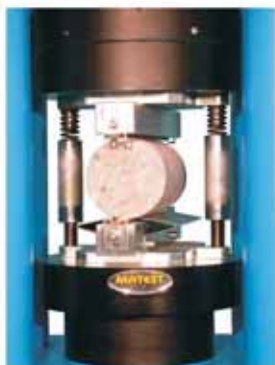
Испытание на раскалывание
