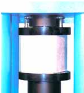
Тест на сжатие бетона
