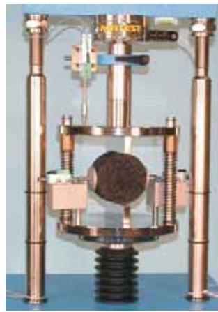
Тест на растяжение при раскалывании
