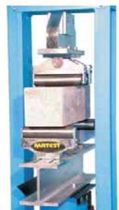
Тест на изгиб бетона
